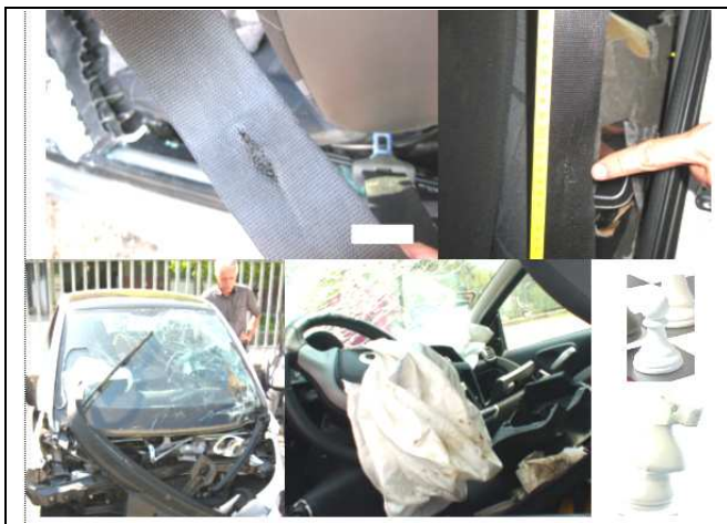
Fig. 6: particolari della cintura di sicurezza e del veicolo, ove la rottura del parabrezza era dovuta al contatto col volante; tra le numerose prove, uno dei fori del nastro, provocati dalla fibbia della cintura dei pantaloni indossata dalla vittima.
