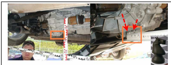
Fig. 5: rilevamento di tracce d'asfalto sulla parte inferiore del motore che ha prodotto i due buchi.
